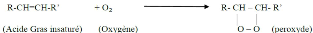
Sur une molécule de peroxyde, une molécule d'oxygène est fixée. Sur les deux atomes d'oxygène fixés ; un seul est actif et est capable d'oxyder les iodures selon la réaction suivante :
