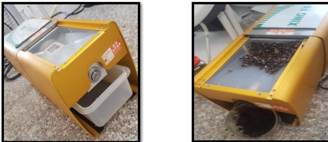
**Figure 15 :** Extraction d'huile végétale à l'aide d'une presse à huile.
